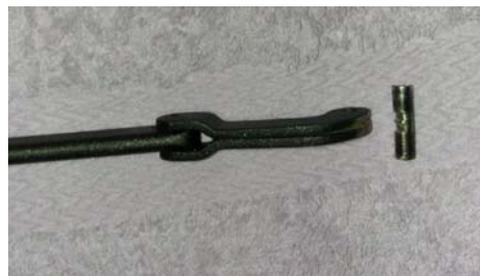
Estas imágenes, son del pasador que sujeta la palanca de carga al cañón. La deformación que se aprecia la ha producido el golpe que da la palanca de carga a cada disparo (F3), lo mismo puede pasar en la articulación de la palanca (F2).
