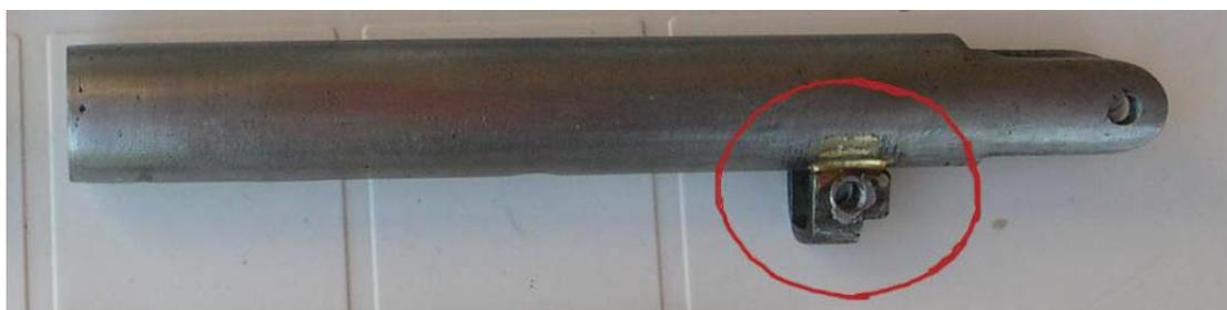
Otra avería que se puede producir, para mí la más importante, es la rotura del pistón o la deformación de su parte trasera. En la imagen siguiente, se aprecian las soldaduras realizadas para reparar el pistón.
