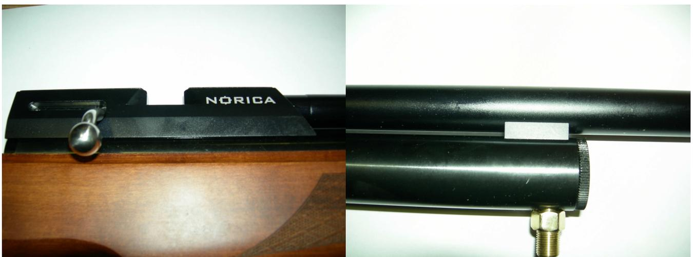
La carabina carece de sistema de puntería, tiene carril de cola de milano de 11mm y cañón tipo bull barrel semiflotante el mismo que monta la Air Arms Xtra HP.
