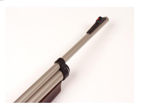
El cañón es de una sola pieza, fabricado en tubo de acero de alta calidad, obtenido por extrusión. Es estriado con 6 estrías dextrosum, que permite alcanzar una buena precisión. El calibre es de 4-5 mm. (.177"). El tubo esta fabricado en níquel semimate, se encuentra superpuesto al tubo en el que se aloja la planta de poder de la carabina.
