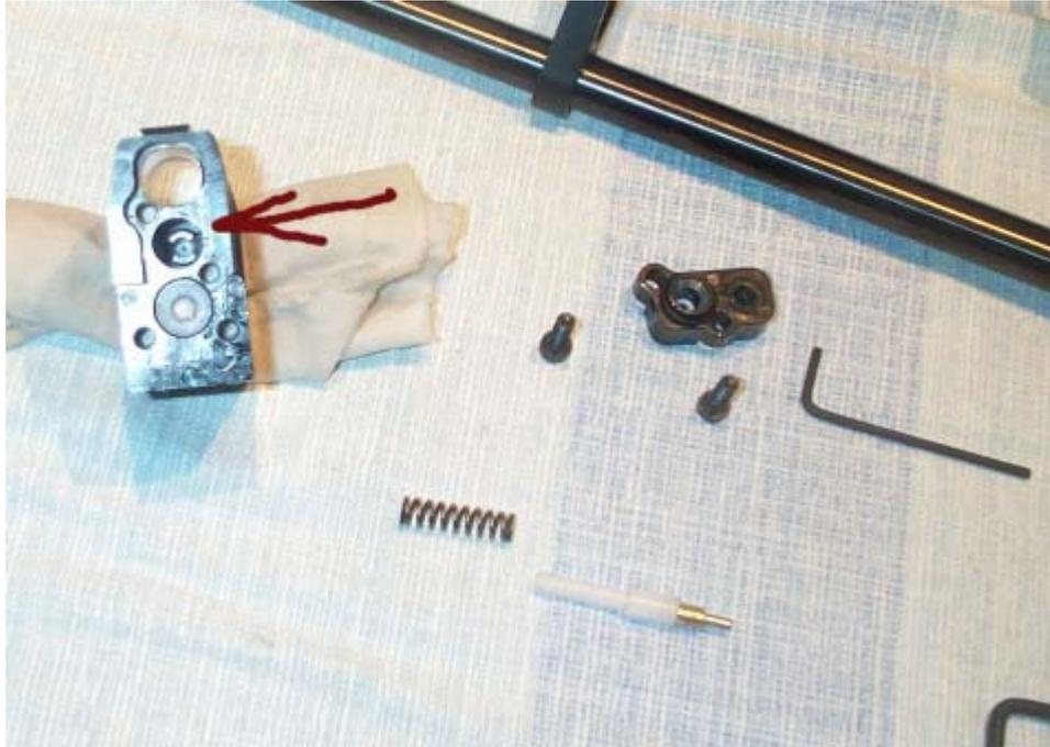
El montaje de los elementos en la cavidad del bloque se realizará colocando primero el muelle en el mismo, en los rebajes establecidos al efecto. Se introducirá después el vástago con su tope guía, y la caja. Hay que prestar atención a que la junta tórica este perfectamente asentada y lubricada. Para apretar los tornillos lo haremos con giro parciales y alternos, presionando la caja de la válvula hacia su posición para evitar cualquier movimiento.
