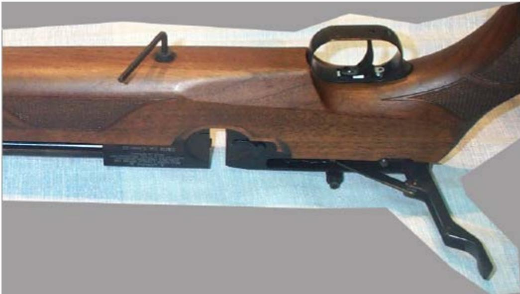
En el caso de ajustes de energía, o en el caso de que no se actúe sobre la caja de la válvula, el cañón no es necesario desmontarlo del bloque de disparo, pero siempre que vayamos a actuar sobre la caja de válvulas deberemos desmontarlo del bloque de disparo, siendo indiferente el momento o el orden del despiece de los diversos bloques, pero esto, será necesariamente antes de desmontar la caja de la válvula.
