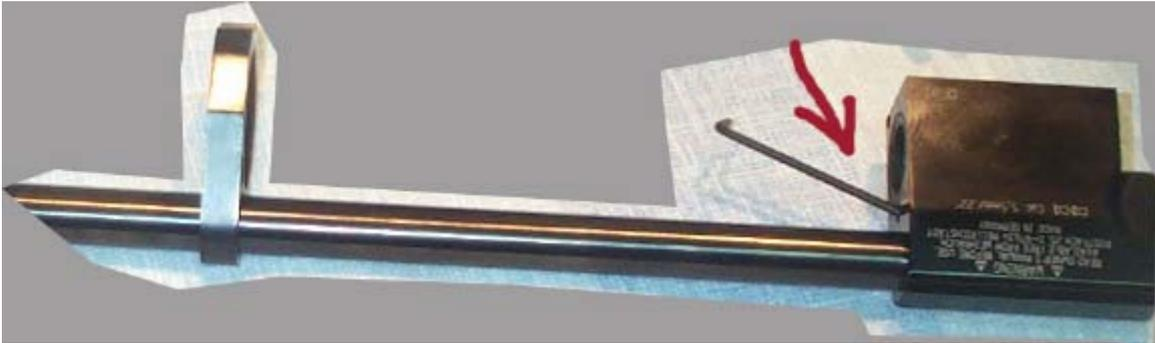
Retiraremos el cañón del bloque de disparo, actuando en el tornillo allen situado en la parte inferior del cañón y sobre la parte superior de la rosca del depósito de aire.
