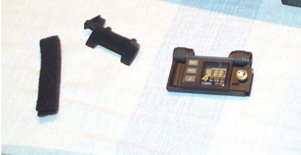
Una vez que hayamos vuelto a montar todos los bloques que conforman la weihrauch HW100, realizaremos una tirada cronografiada, donde observaremos la regularidad de los disparos y su precisión. Si todo lo hemos realizado correctamente observaremos mediciones de menos de 1,2 metros por segundo, y por supuesto, a una distancia de 10 metros, agrupaciones mono agujeros de menos de 6 milímetros.
