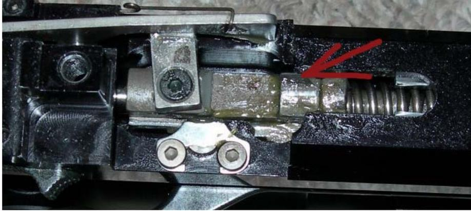
Todos los elementos de muelles, del bloque de cerrojo los lubricaremos con grasa de litio. Las partes móviles con aceite mineral. El cuerpo exterior con aceite de armas, o en su defecto con aceite mineral. El eje de rotación del cargador con aceite mineral, y de la misma forma la tórica del cargador.
