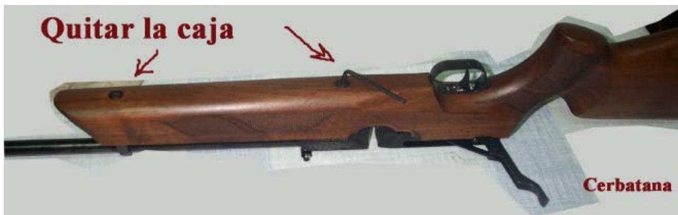
Ahora una precaución muy importante, pues en los próximos pasos accederemos a la caja de válvulas, aunque hemos retirado el depósito de aire dentro del conjunto aún hay presión, para eliminarla se dispara en vacío y asunto arreglado. Comprueba que no hay ningún balín en el cañón y que el cargador ha sido retirado. Trabaja pero seguro.
