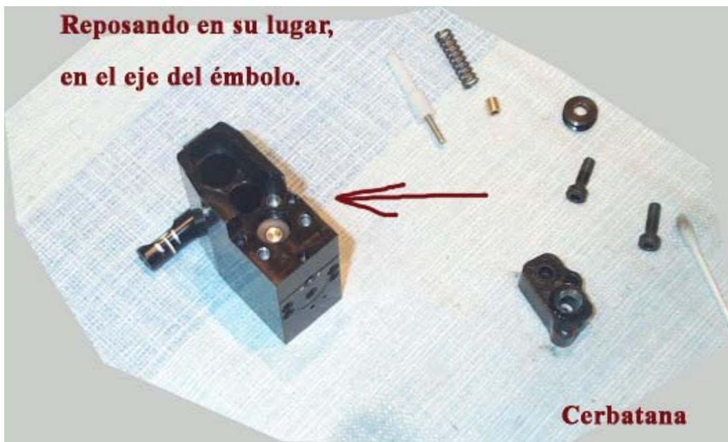
Ahora volvemos a colocar en su posición la tuerca de regulación y tope. El muelle de la válvula, el vástago y el tope del mismo. Tanto el vástago como el tope los habremos limpiado con un papel seco y libre de impurezas. Atención especial a la junta tórica cuando se monte la caja de la válvula.
