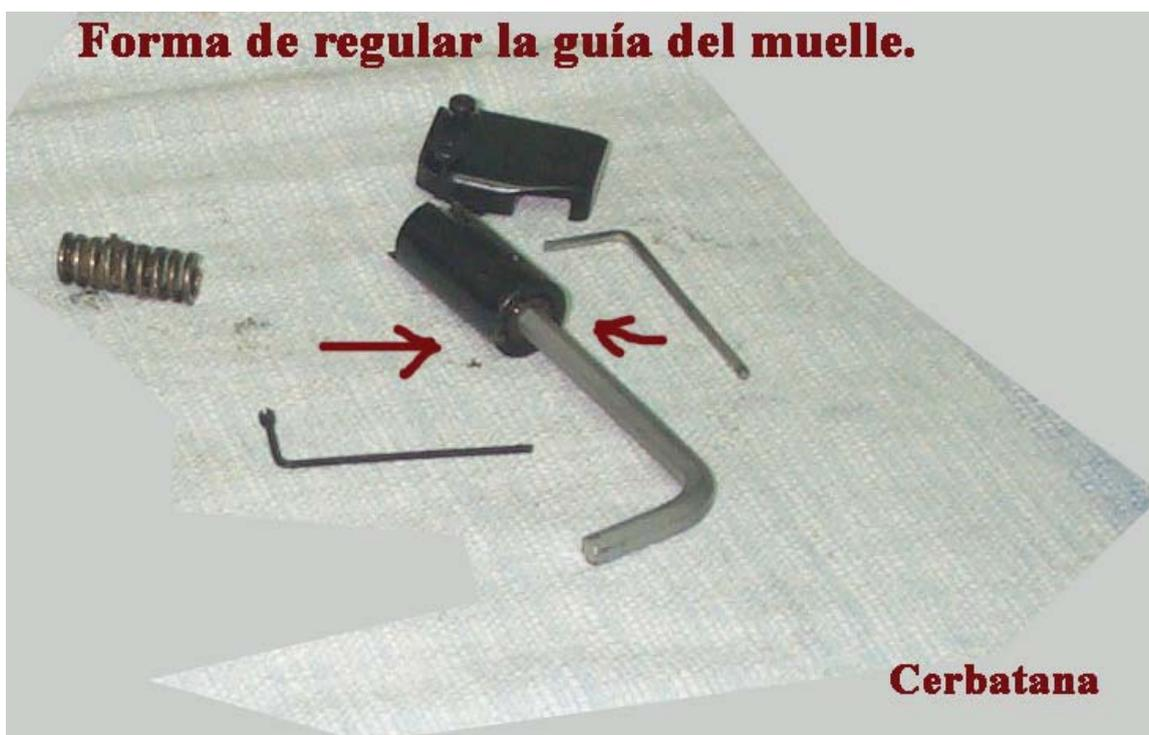
Forma de medir el desplazamiento que hayamos calculado. El ajuste de eficacia de consumo de aire es aquí donde se determina. Esta masa de inercia con la correspondiente compresión del muelle evitará consumos de aire innecesarios.
