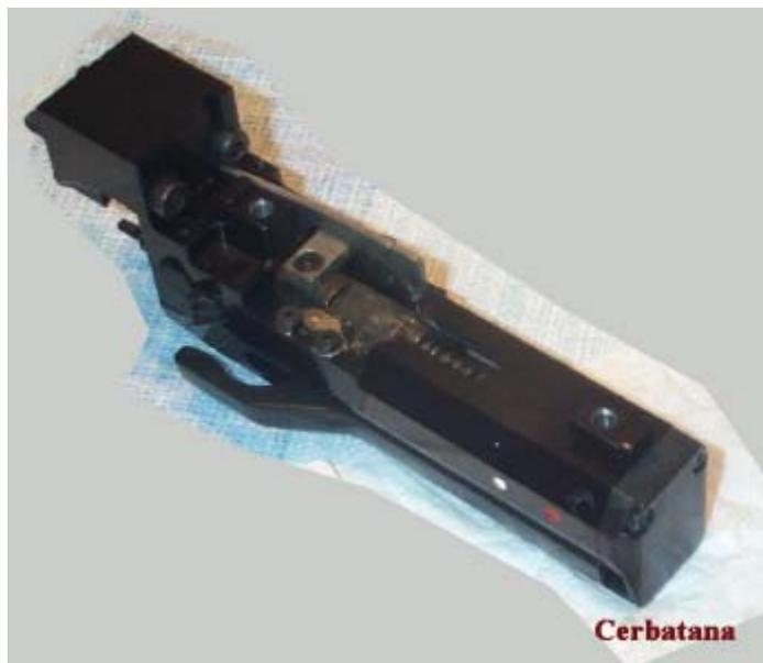
Ahora continuamos viendo como se desmonta la caja de la válvula. Recordemos que hemos purgado el aire remanente disparando una vez retirado el depósito de aire, esto es muy importante.
