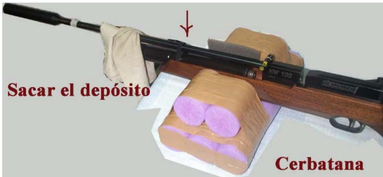
Sacar la caja, aflojando los dos tornillos de la misma.
