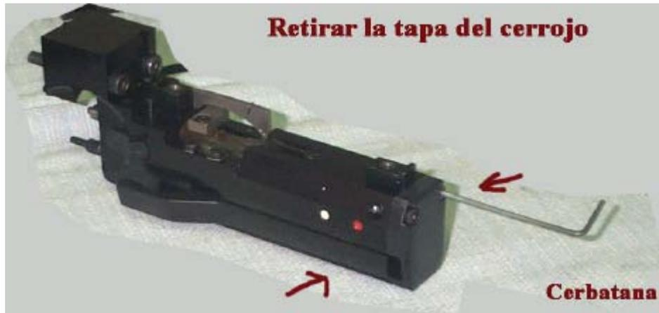
Desplazar el pasador de la base de la palanca. Con el ángulo que se ve en la fotografía prácticamente baja solo. Antes de volver a montar la palanca es conveniente lubricar el pasador con generosidad.
