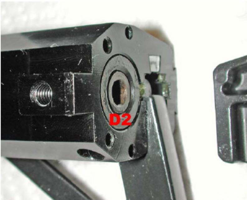
Para bajar el bulón de la palanca de montaje dejarla con una abertura de 30 grados y prácticamente baja solo. Inclinarlo y sale el cilindro del muelle y su guía.
