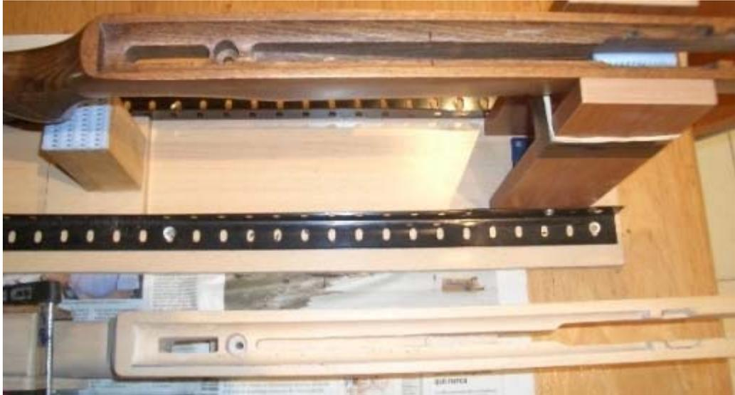
Y como ya teníamos la "idea" y un mecanismo de carabina con sus complementos (visor y bocacha), pues comprobamos su acople con la pieza de madera:
