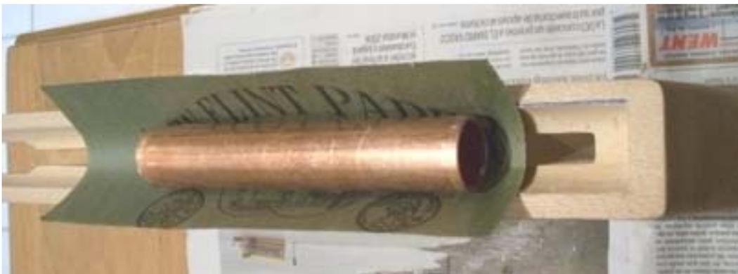
Importantísimo confeccionar una plantilla para comprobar continuamente que vamos consiguiendo la curvatura exacta que nos exige el mecanismo del arma:
