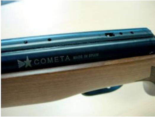
La cámara de potencia va provista de dos rebajes aptos para montar cualquier tipo de visor o punto rojo y va provista de orificios aptos para lo colocación de “stoppers”, que aseguran el visor de forma que no se desplace hacia atrás y evitar que se salga del carril. No hay que olvidar que estamos ante una carabina de alta potencia y el retroceso inverso es elevado.
