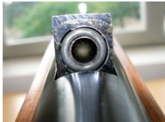
El cañón de 28 cm de longitud luce un magnifico estriado, que le dará al balín el movimiento rotatorio necesario para su estabilidad durante el vuelo. La impresionante bocacha corona el cañón dándole un “look” muy al estilo de las carabinas inglesas, que adornan sus cañones con bocachas y silenciadores.
