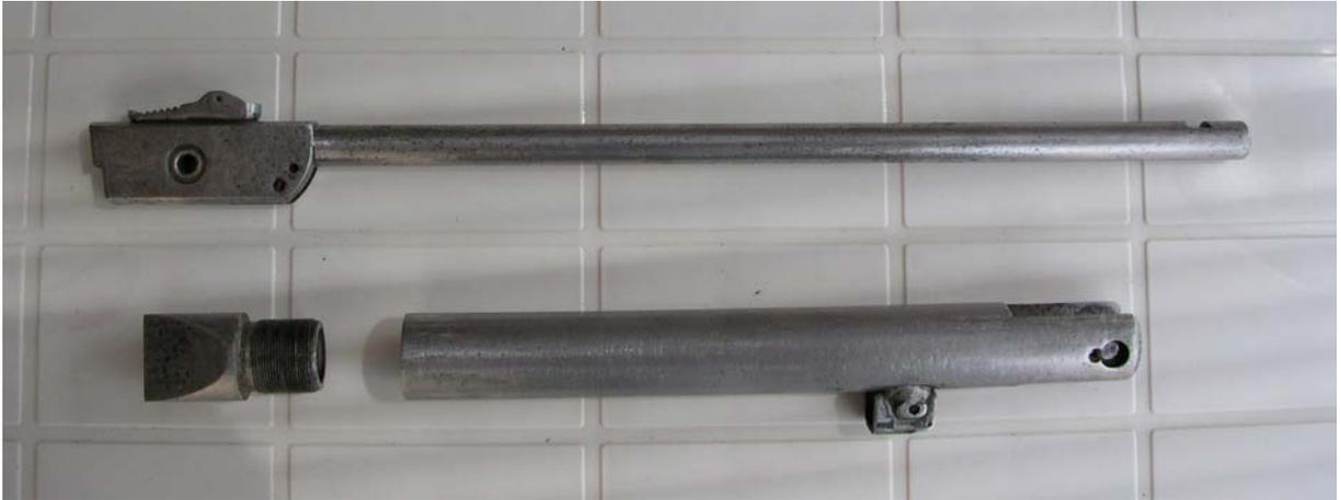
Para pavonar las piezas, he utilizado dos métodos distintos. Uno en frío para las piezas grandes, como las de la fotografía anterior y el otro en caliente para las piezas pequeñas. Este método también se puede utilizar en las piezas grandes, siempre que se alcance la misma temperatura en toda la pieza, de lo contrario el color se degradará en función de la temperatura alcanzada en cada parte de la pieza.
