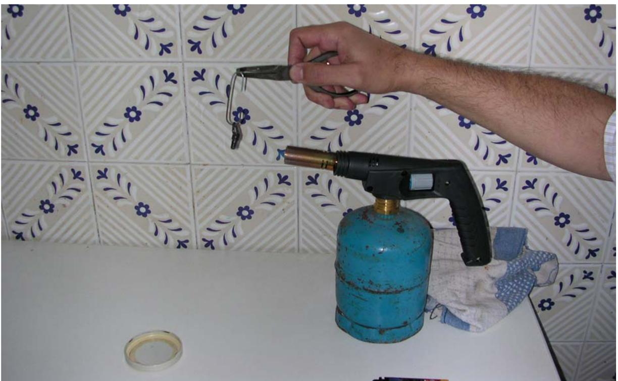
Después de calentar la pieza a la temperatura deseada, se sumerge en aceite de automóvil, si es usado mejor, y se deja enfriar.
