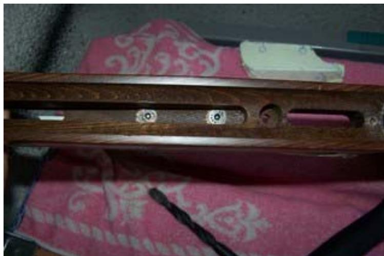
Después en el centro metemos un taladro del grosor del tornillo que meteremos por el otro lado, por el otro lado avellanamos la madera con una broca del tamaño de la cabeza, esto lo haremos con la broca en la mano, así no rozaran con los mecanismos.
