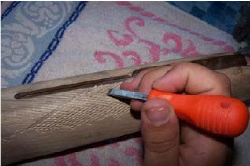
Para hacer el tallado en forma de rombo, primero marcaremos unas líneas maestras, en forma de forma del ángulo del rombo, después con un cartón trazaremos líneas perfectamente paralelas en un sentido y en otro de manera que dibujen rombos.
