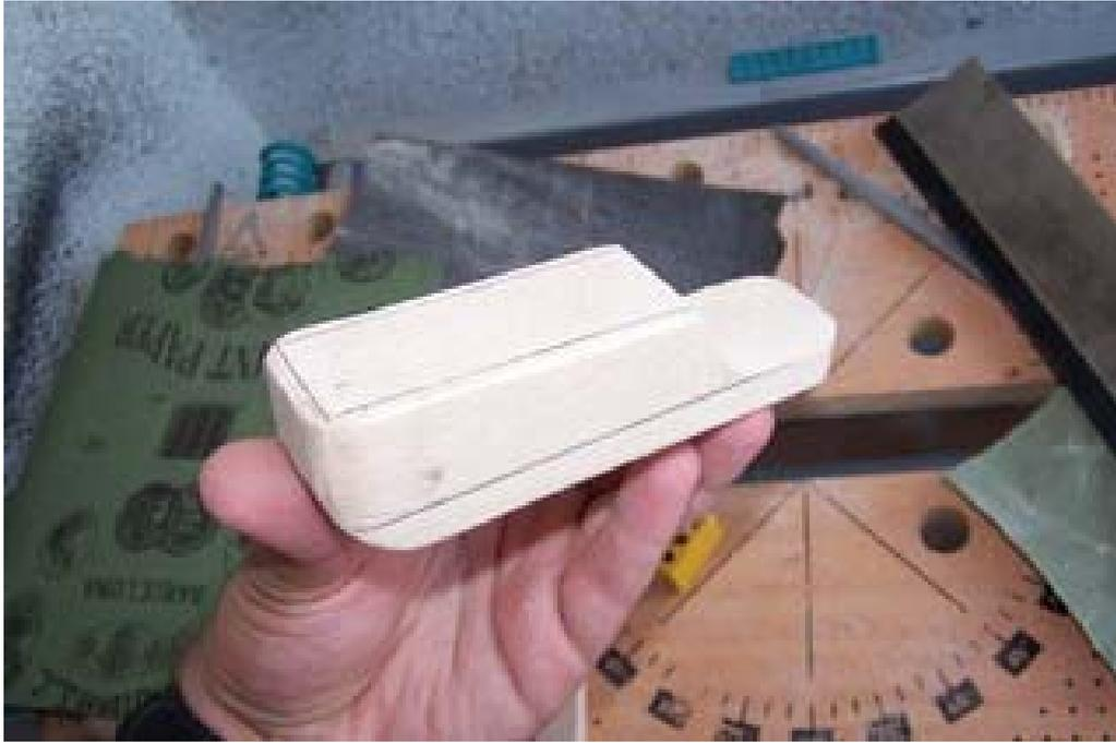
Partiendo de un taco de madera con la forma que previamente hemos visto que funciona, marcamos y cortamos con una sierra de madera.
