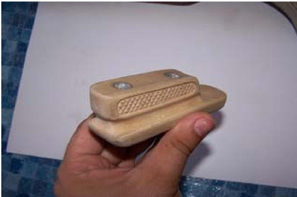
Usando las técnicas antes mencionadas, un tubo como camisa por el que se desliza la guía hasta abajo, el picado de rombos y usando limas redondas, planas, fresas redondeadas para el contorno del picado, etc. realizamos la seta, por el lado opuesto, pues lo mismo, tuercas embutibles pero más pequeñas de 12mm de diámetro y tornillo prisioneros de métrica 6, y mucha, mucha lija.
